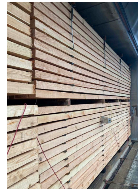
... in der mit der Schnitzelheizung betriebenen Trockenkammer zu trocknen.
