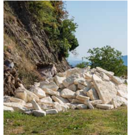
Aus diesen Malmkalkbrocken entstehen die neuen Trockenmauer-Steine.
