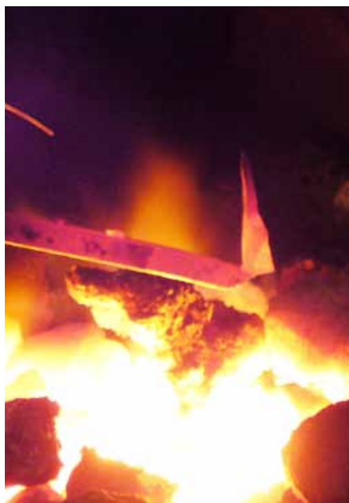
Das Endprodukt Eisen muss zur Bearbeitung auf 700 Grad erhitzt werden. Foto: Schmiedeverein
