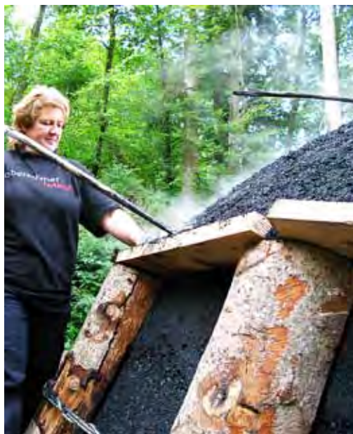
Löcher durch den «Löschimantel» zu stechen, erfordert viel Kraft.
